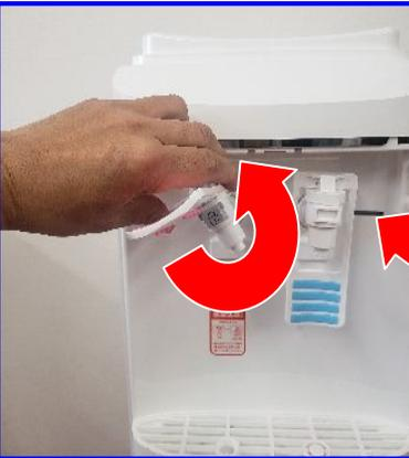
ウォーターサーバーの冷・温水コックを交換する際の手順 ~その2~
