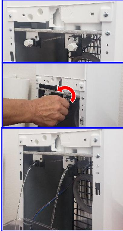
② 排水キャップ左右2箇所を時計回りの反対方向へ回して取り外す。冷温水ともに排水口より出なくなるまで取り出してください。
