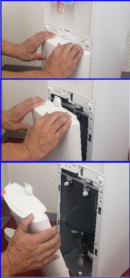
① 前面パネルを下方方向に押しながら手前に引き分離する。
